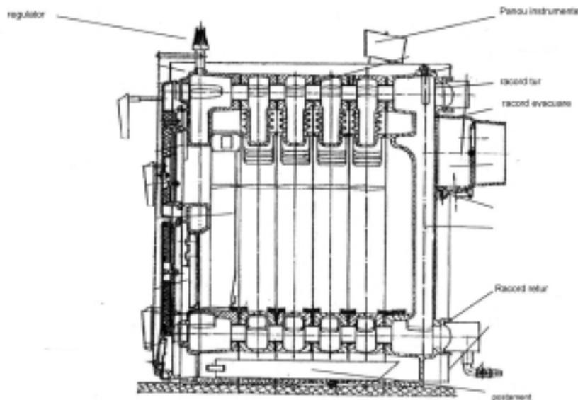
**Fig 3 Vedere laterala a cazanului(fara manta si izolatie)**
